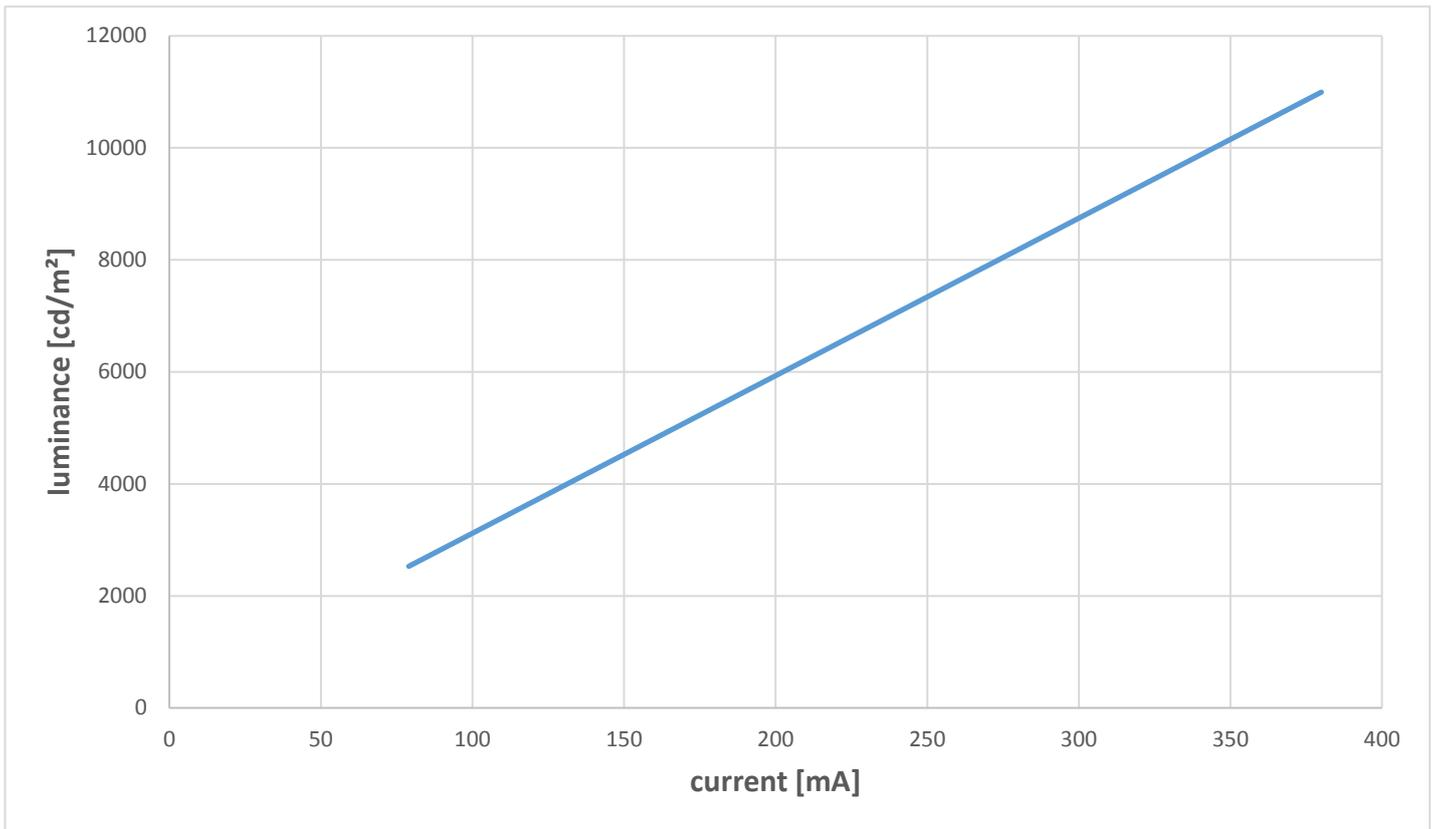
図 8 : 室温における輝度 vs 順電流の関係特性 (集積レベル 1)
