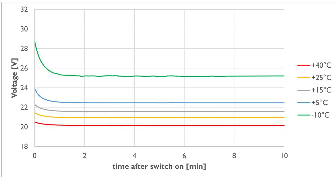
図 5 : 各種の大気温度下で起動した後の駆動電圧の低下 (LumiCurve Wave FL300C ww、定電流 ( $I = 295 \text{ mA}$ ))
