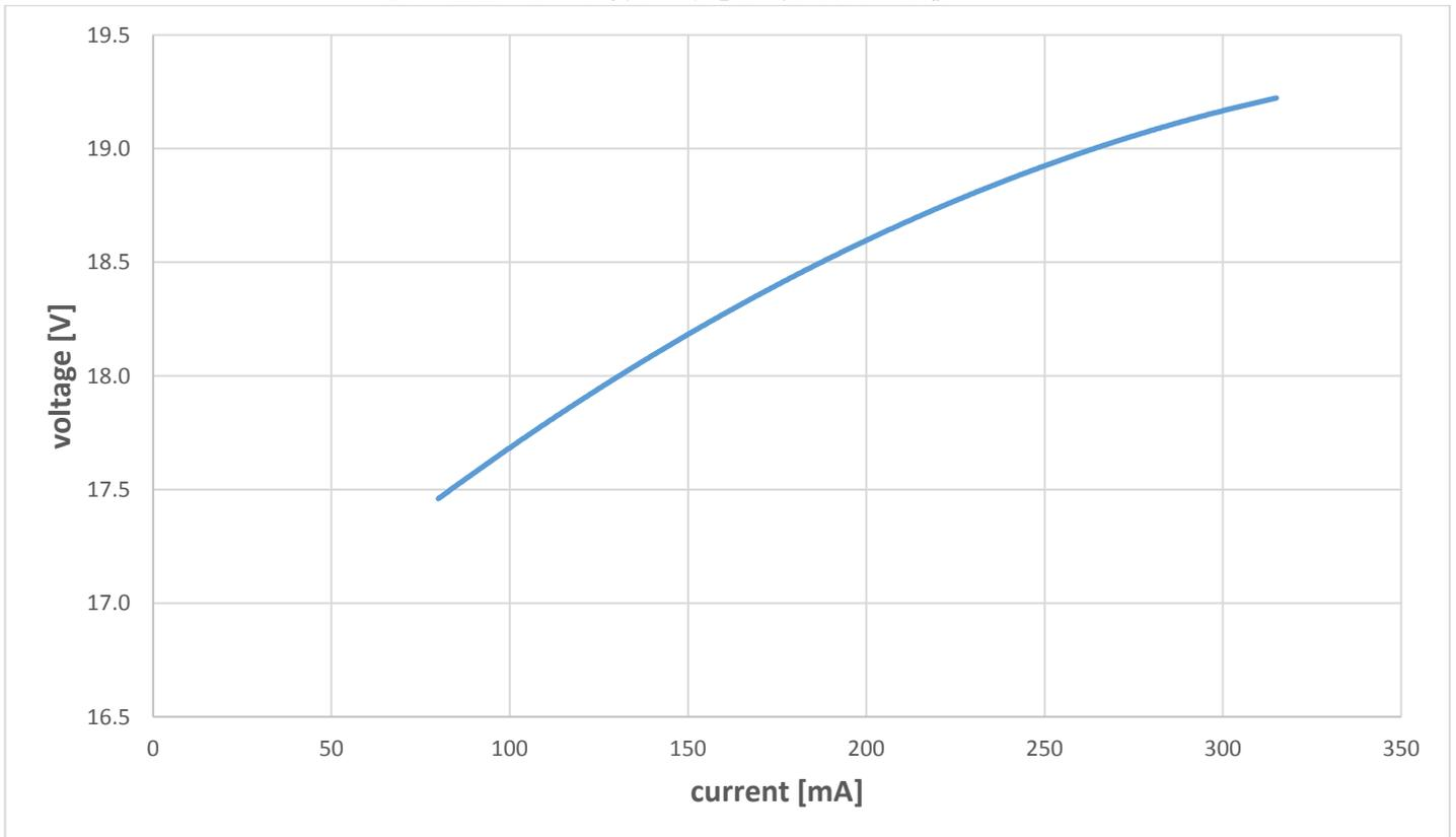
図 9 : 室温における電圧 vs 順電流の関係特性 (集積レベル 1)
