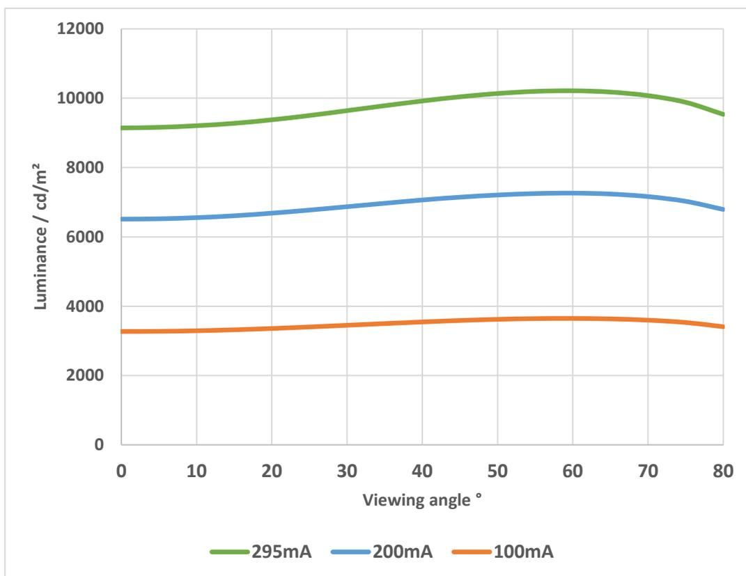
図 13 : 輝度 vs 視野角 (駆動電流  $I = 0.100 A, 0.200 A, 0.295 A$ )
