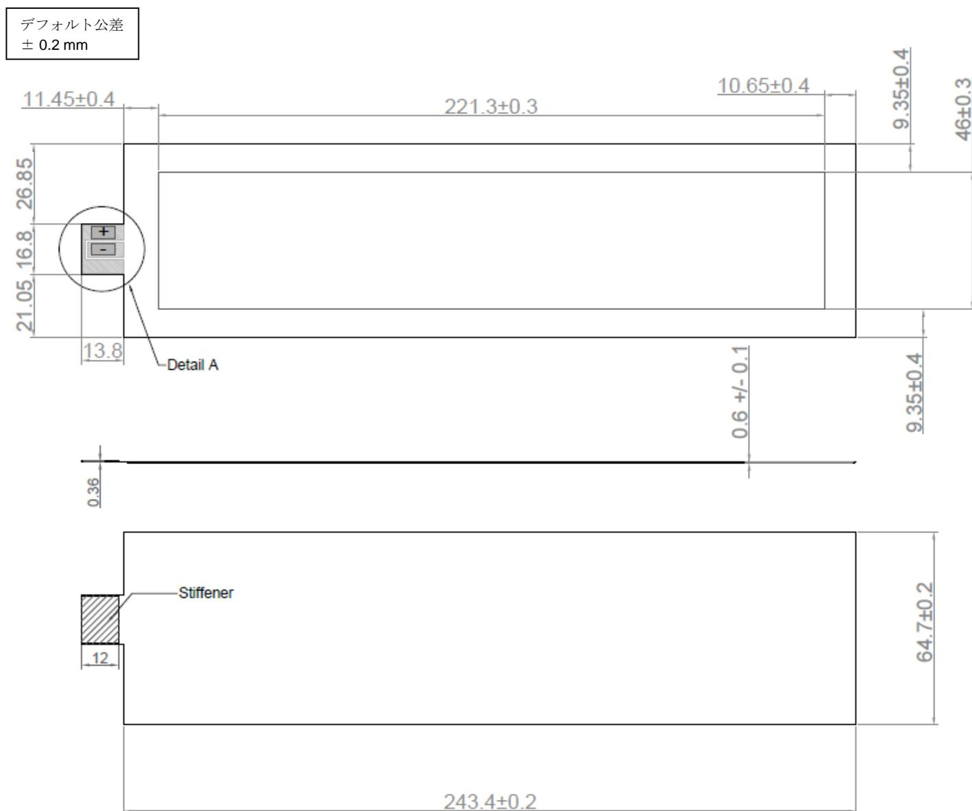
図 1 : LumiCurve Wave FL300C ww Level 1 – 正面図 (上)、側面図 (中央)、背面図 (下)
