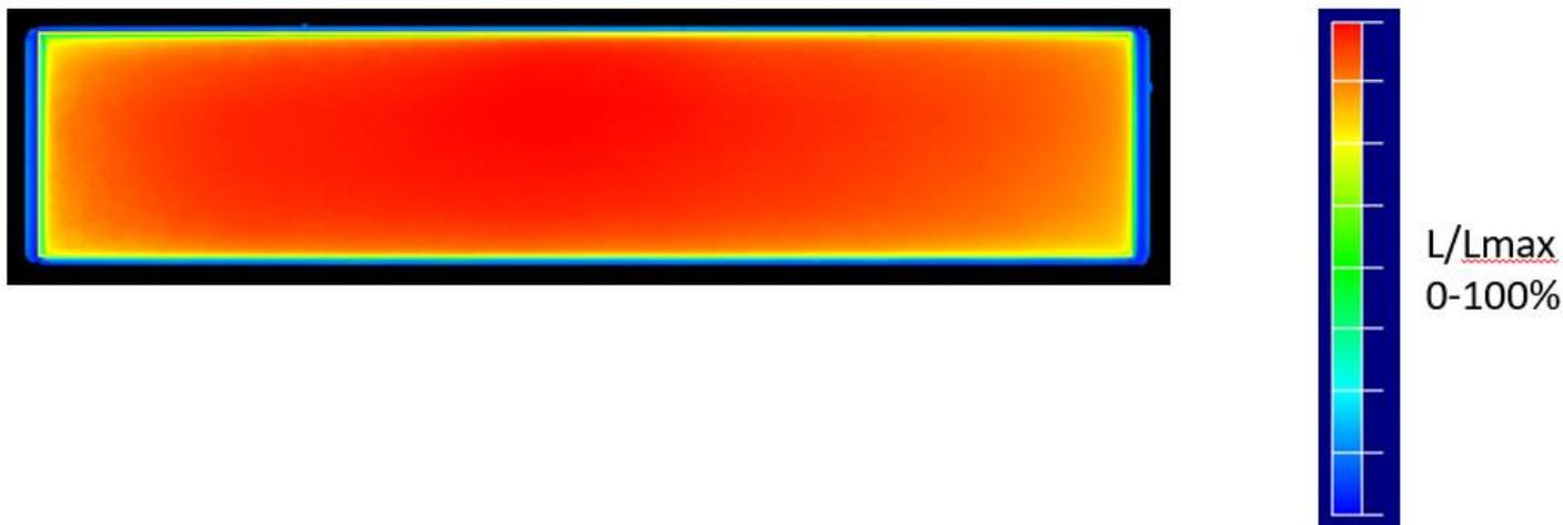
図 12 : LumiCurve Wave FL300C ww (集積レベル 1) の代表的な輝度分布 - 動作条件 : 大気垂直方向、RT (= 25 °C)、 $I = I_{in rated}$
