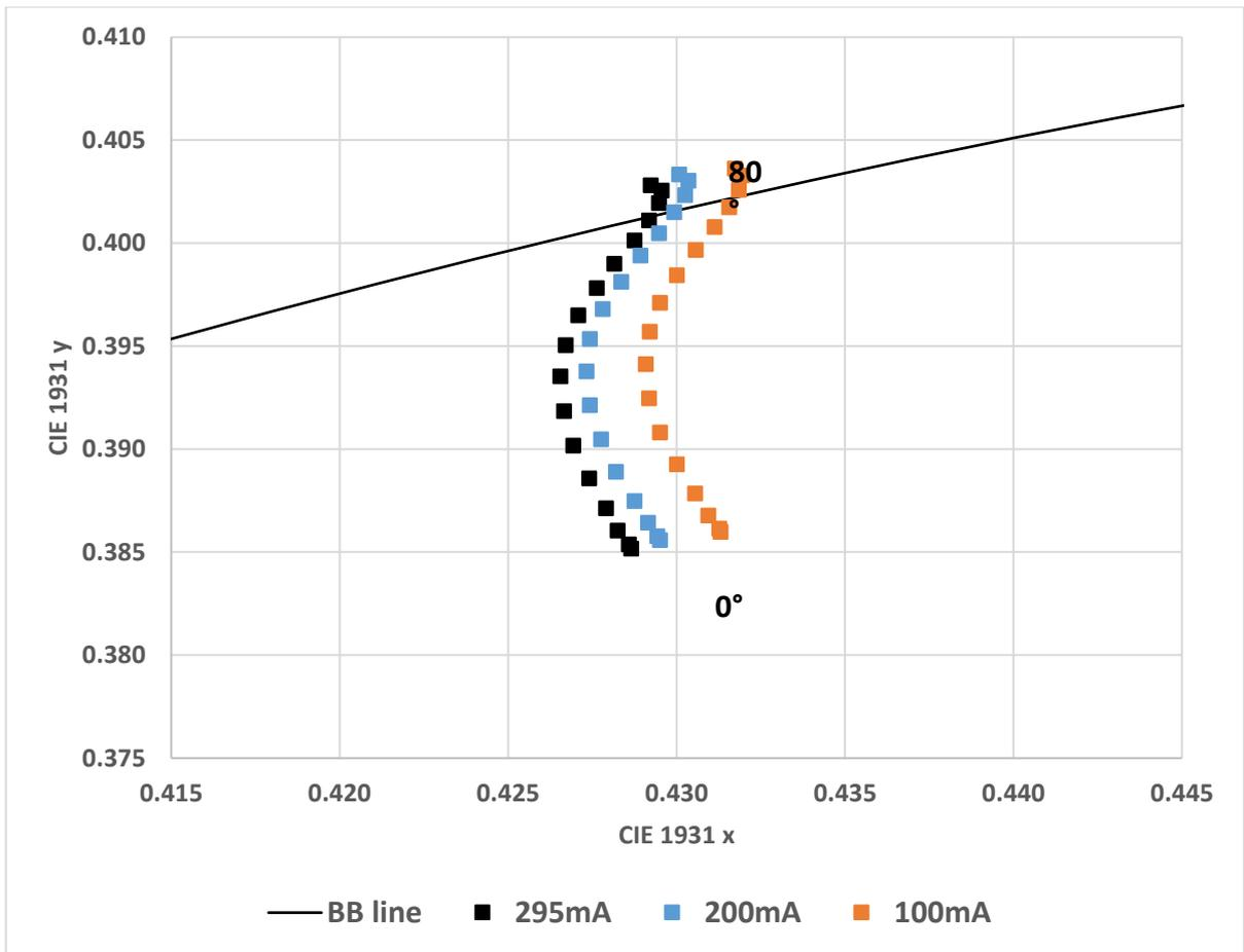
図 14 : CIE x/y vs 視野角 (駆動電流  $I = 0.100\text{A}$ ,  $0.200\text{A}$ ,  $0.295\text{A}$ , 集積レベル 1.5)
