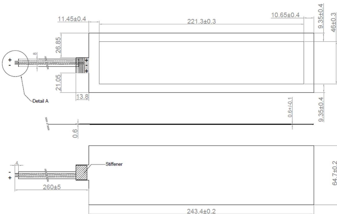
図3 : LumiCurve Wave FL300C ww Level 1.5 – 正面図 (上)、側面図 (中央)、背面図 (下)
