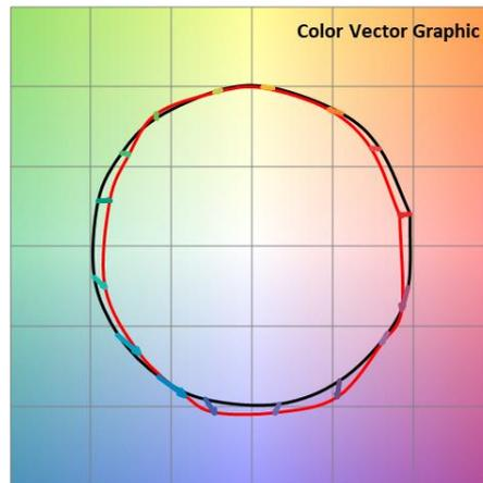
図6：TM-30 メトリクスに基づく色ベクトル (LumiCurve Wave FL300C ww)
