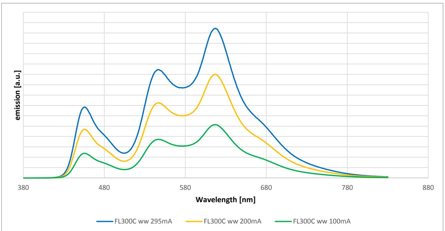
図7：各種の駆動電流で動作する LumiCurve Wave FL300C ww の代表的な放出スペクトル ( $I = 0.100 \text{ A}, 0.200 \text{ A}, 0.295 \text{ A}$ )
