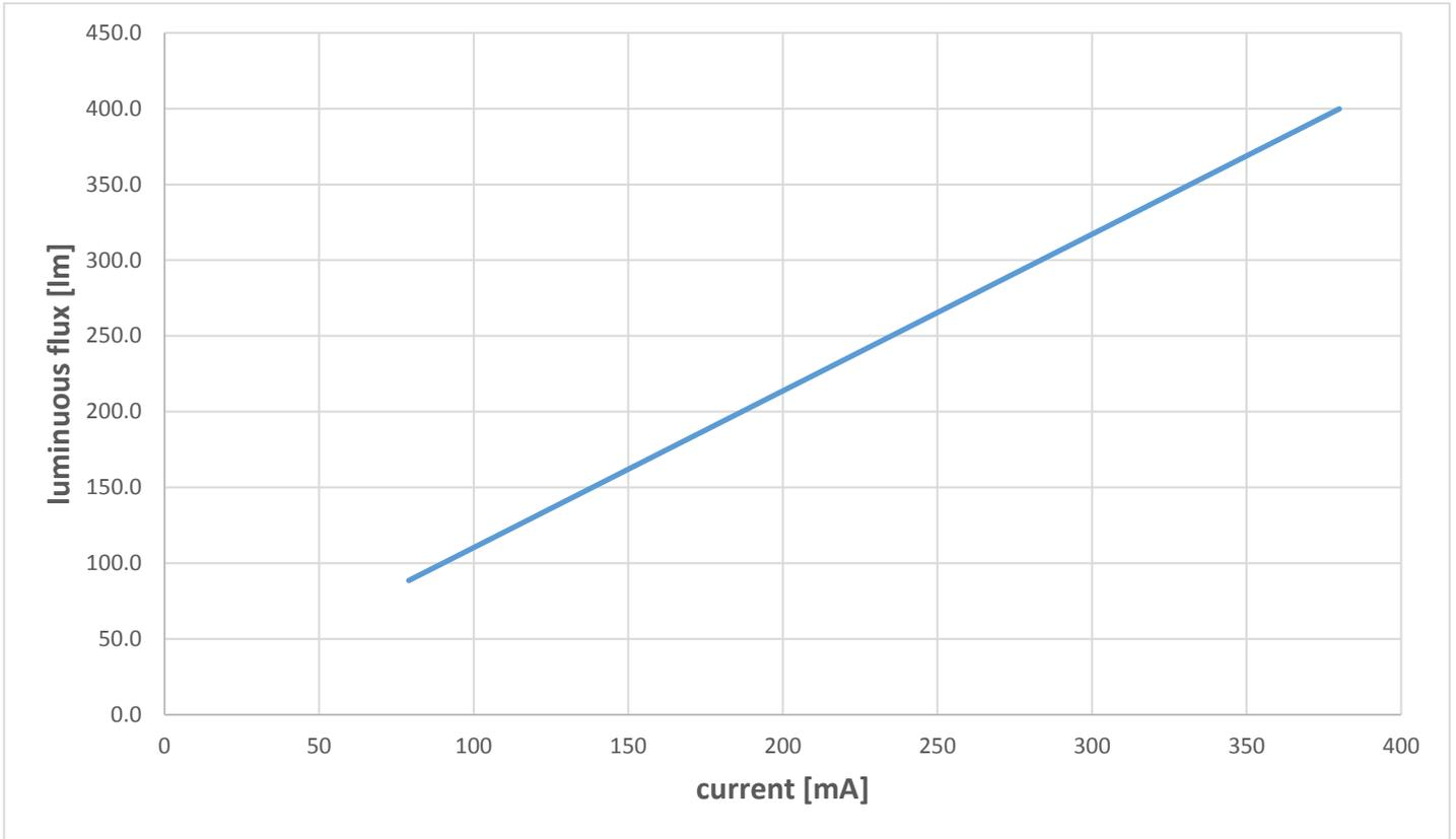
図 10 : 光束 vs 電流の関係特性 (集積レベル 1)
