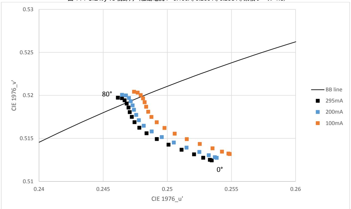
図 15 : CIE u'/v' vs 視野角 (駆動電流  $I = 0.100\text{A}$ ,  $0.200\text{A}$ ,  $0.295\text{A}$ , 集積レベル 1.5)
